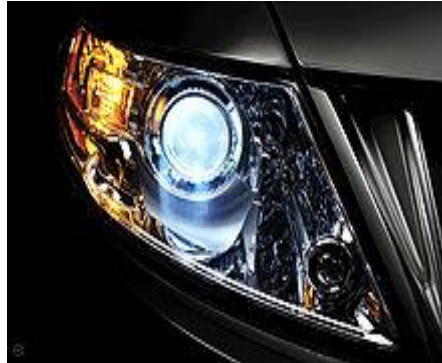
Figure. I.7 : Phare à décharge au xénon. [20]
