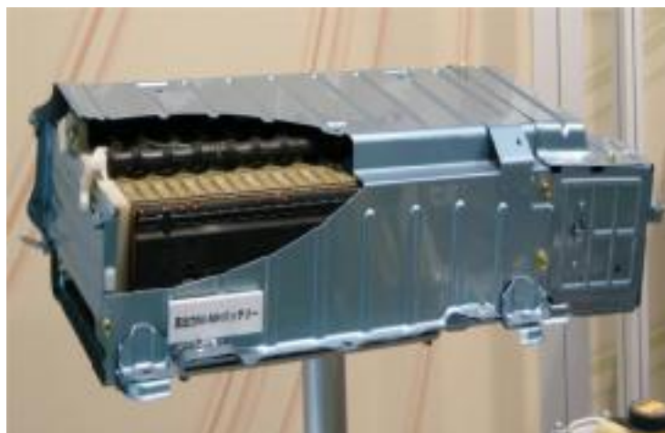
Figure II.3. Batterie Ni-Mh d'une Toyota Prius seconde génération.
