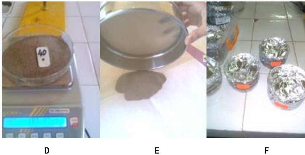
Fig. 9 :Détermination de la masse du sédiment sec pour l'opération de tamisage (D) ; Refus récupérés dans des boîtes (E et F).
