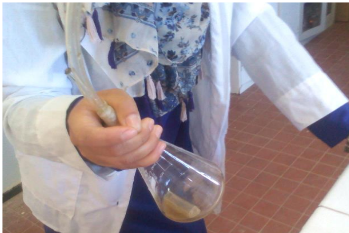
Fig. 16 : attaque de l'échantillon l'acide chlorhydrique en renversant l'Erlenmeyer préalablement fermé.
