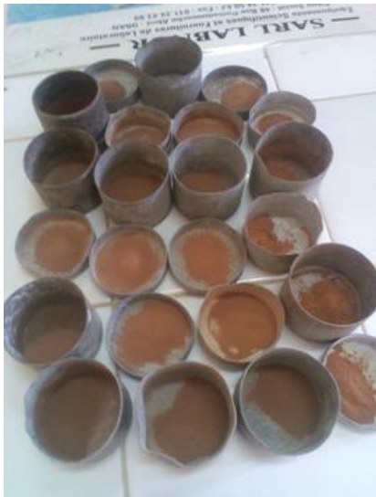
Fig. 12 : Creusets après calcination à 550° C
