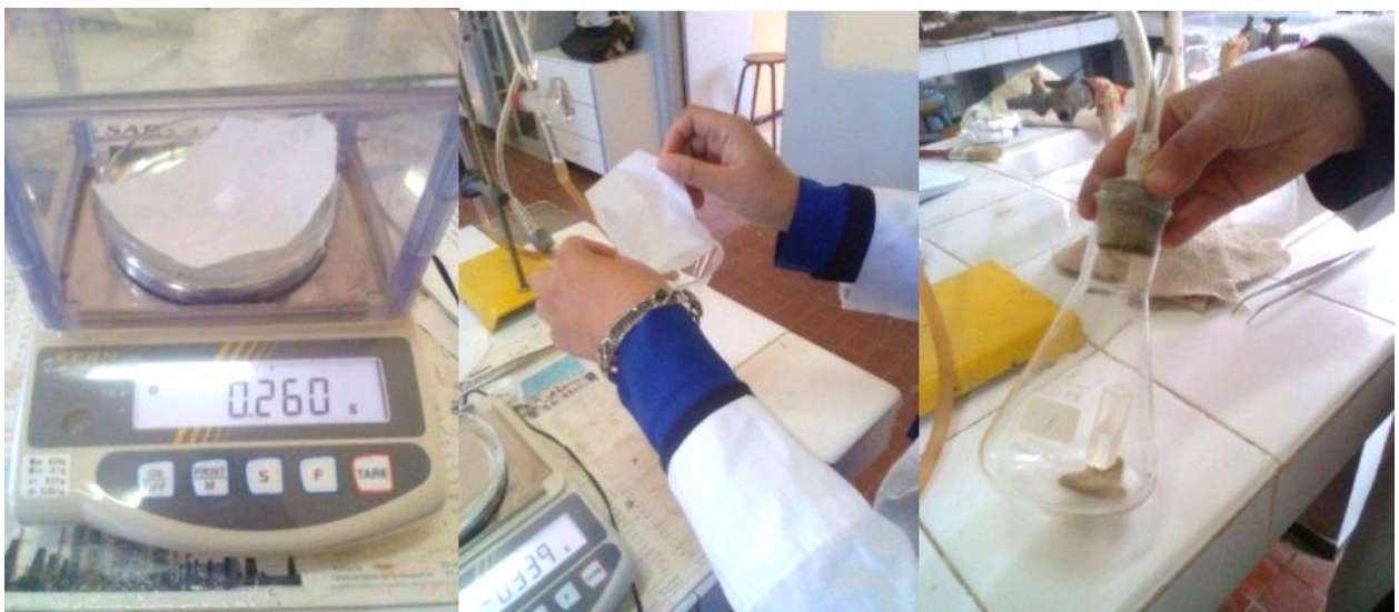
Fig . 14. : Calcimétrie (détermination du taux de carbonates dans le sédiment)
