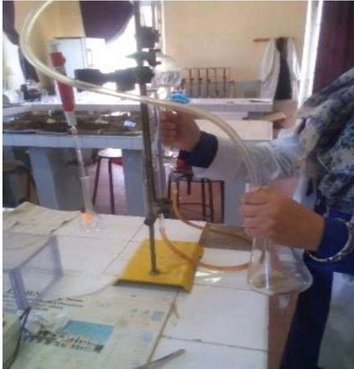
Fig. 15 : Équilibre des niveaux de l'ampoule et de tube gradué.
