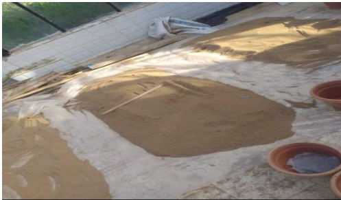
(C) : Séchage du sable à l'air libre
