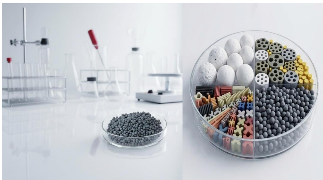
Figure I-2 : Différentes formes de catalyseur utilisés dans l'industrie du raffinage pétrolier
