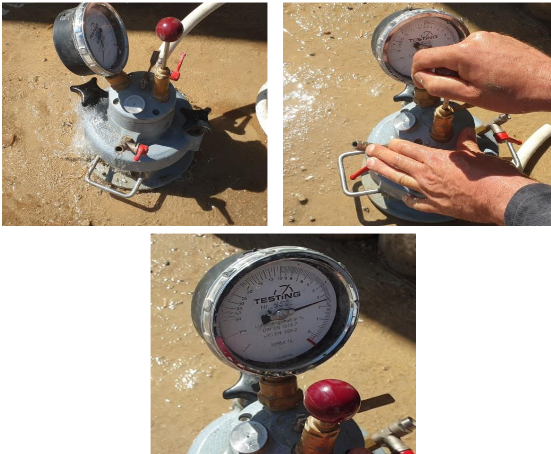
Figure ( III.4) : Essai de la teneur en air.
