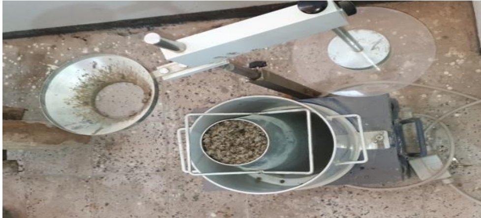
Figure ( II.31 ) : Mise en place du béton dans le cône d'Abrams.
