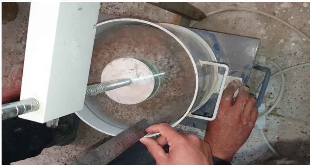
Figure ( II.32 ) : Soulèvement du cône et mesure de l'affaissement A.
