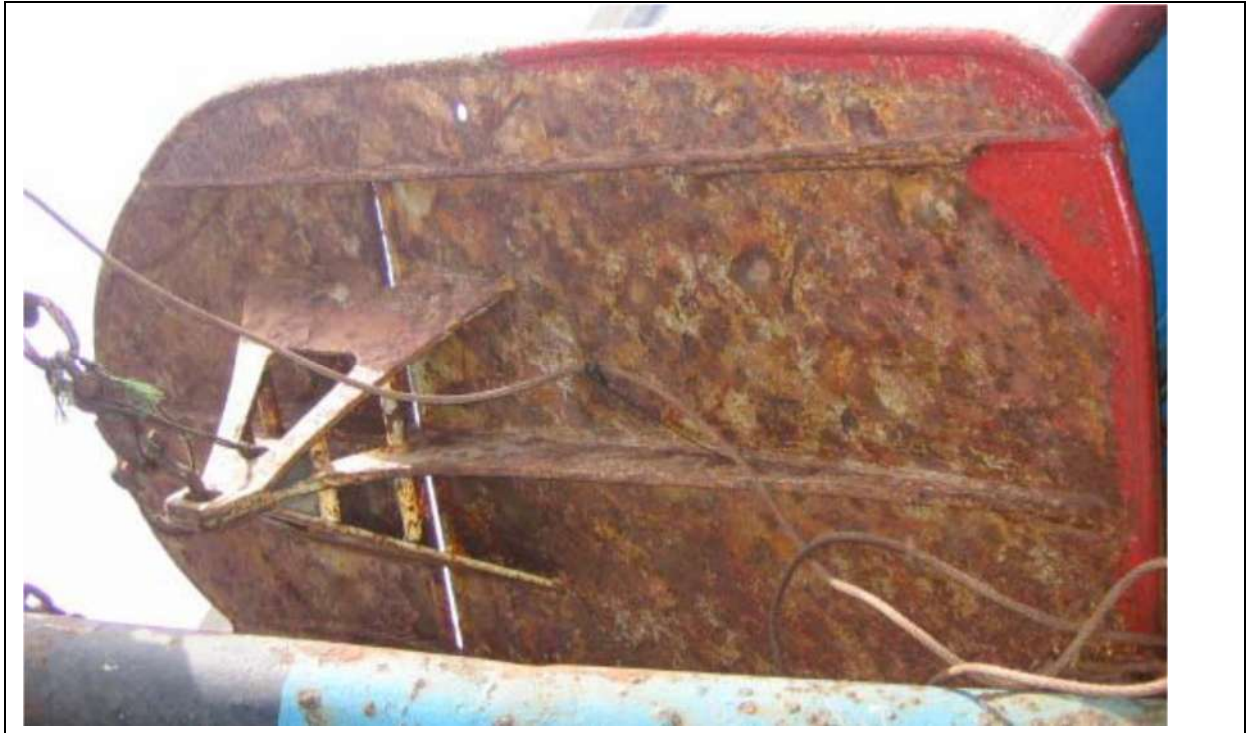
Figure 1. Photo montrant un panneau de fond du type méditerranéen (120 à 150 kg) adapté aux navires de 180 à 400 CV (PRADO, 1988).
