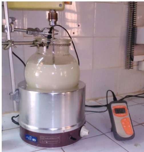
Figure III.1 : Réacteur utilisé pour la synthèse des résines
