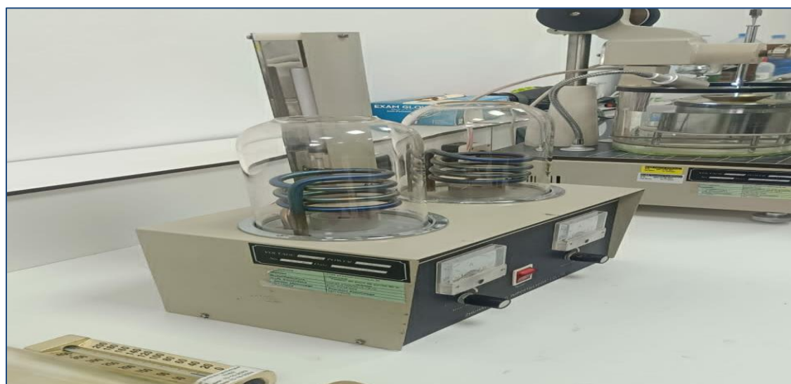
Figure III.12 : Dispositif de préparation de l'essai de pénétration de la graisse.
