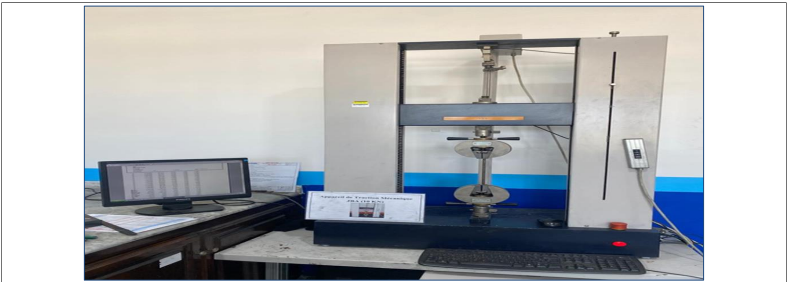
Figure III.5 : Appareil de traction mécanique JBA (10 KN).
