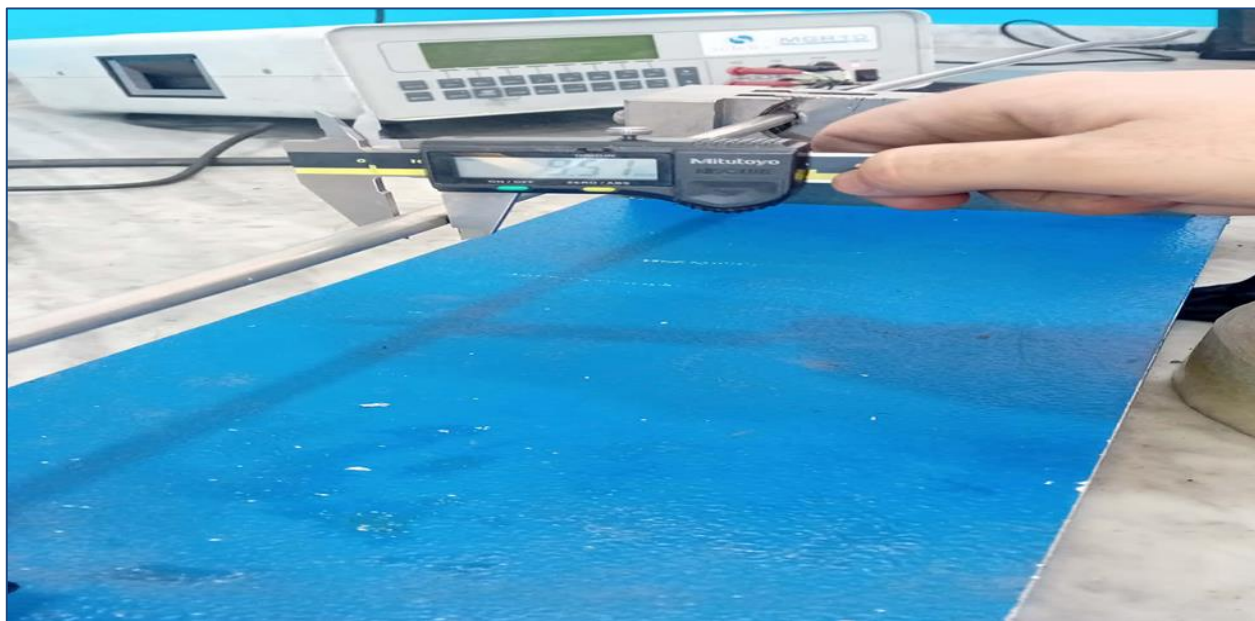
Figure III.3 : Mesure de diamètre de conducteur.
