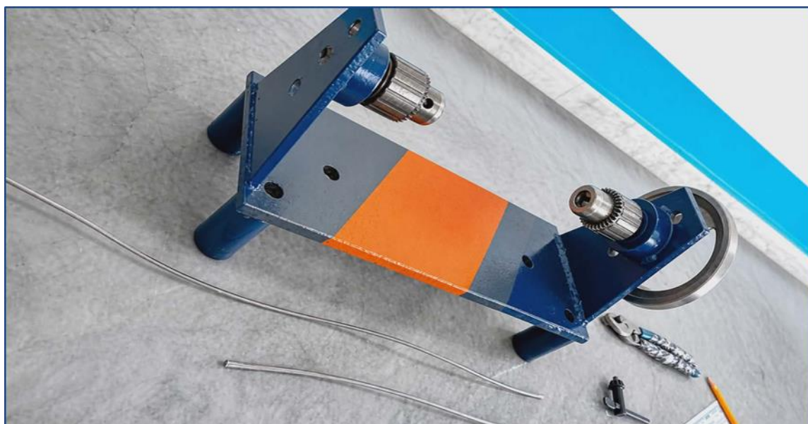
FigureIII.10 : Dispositif utilisé pour l'essai d'enroulement après traitement thermique.
