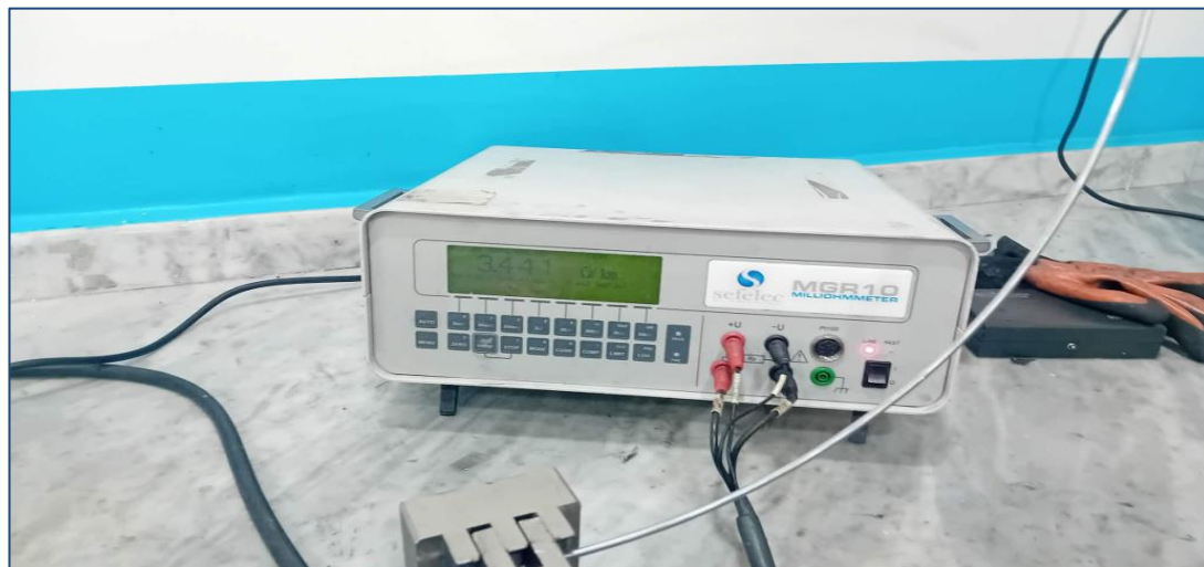
Figure III.9: mesure de la résistance à l'aide d'omettre.
