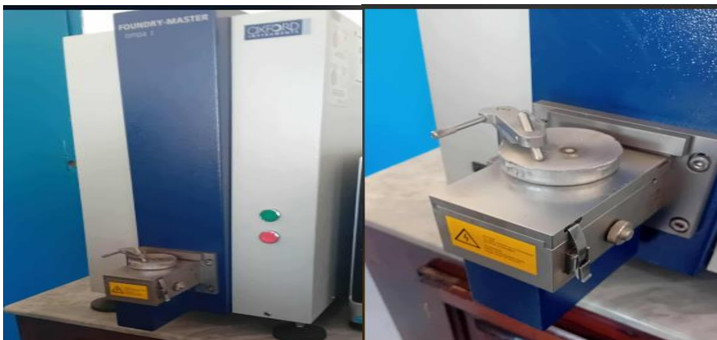
Figure III.1: Spectromètre utilisé pour l'analyse de la composition chimique des alliages d'aluminium 6xxx au sein de GISB
