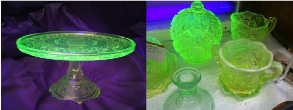
Fig.2 : Divers objets en verre contenant de l'uranium, éclairés sous lumière ultraviolette.(Wikimedia Commons, 2005-2010).
