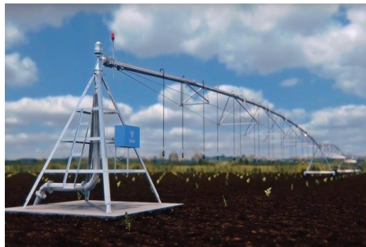
Figure I.8 Irrigation par pivot
