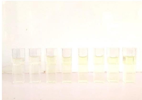
Figure20. Echantillons de chlorophylle « a » prêt pour la mesure au spectrophotomètre.
