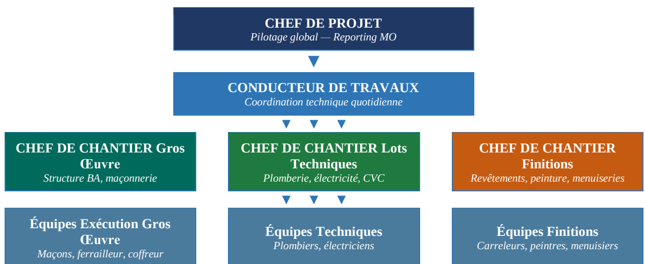
Figure III.7 : Organigramme fonctionnel du chantier de construction
