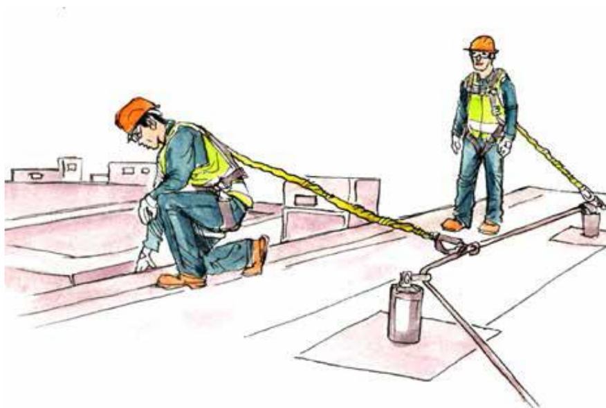
Figure II.12 : Port des harnais et plateforme sécurisée
