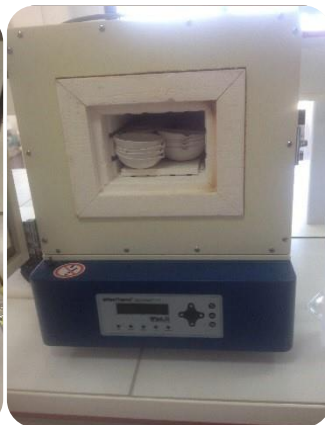
Ph07 : les creusets dans le four à 450°C
