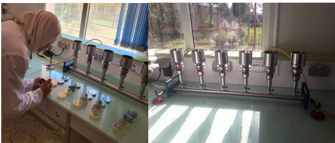
Figure 23 : Présentation de l'appareil de filtration sur membrane au niveau de laboratoire d'analyse
