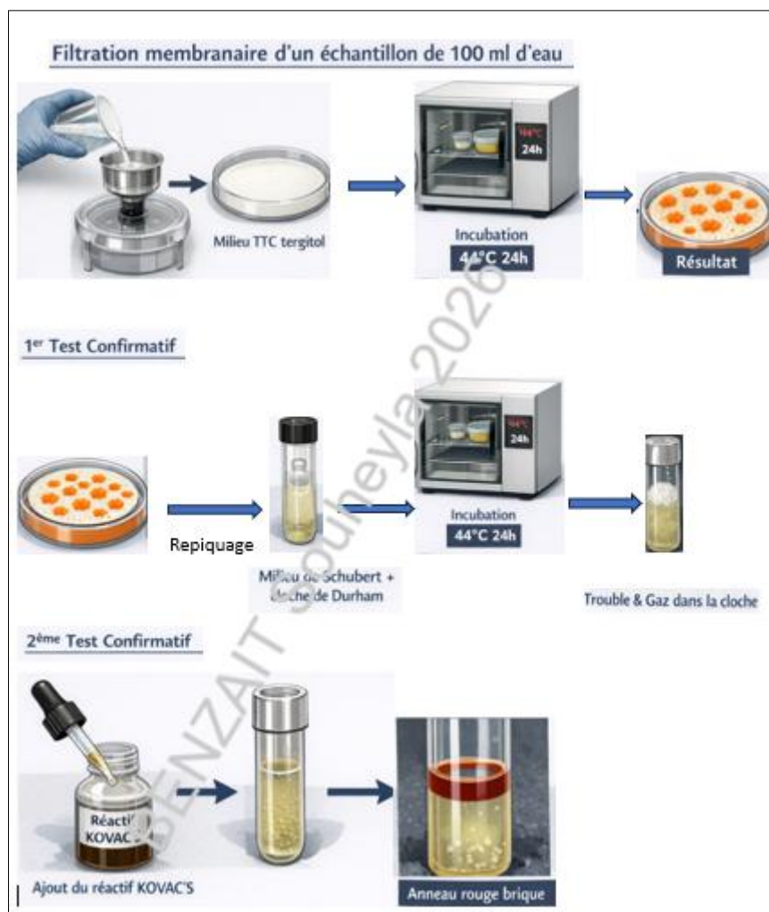
Figure 25 : Protocole d'identification des coliformes fécaux ( Escherichia Coli )
