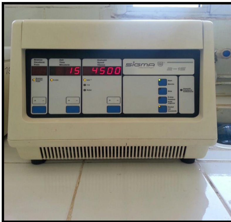
Photo 3 : la centrifugeuse SIGMA réglée à 4500 tours pendant 15 min utilisé pour centrifuger les prélèvements.
