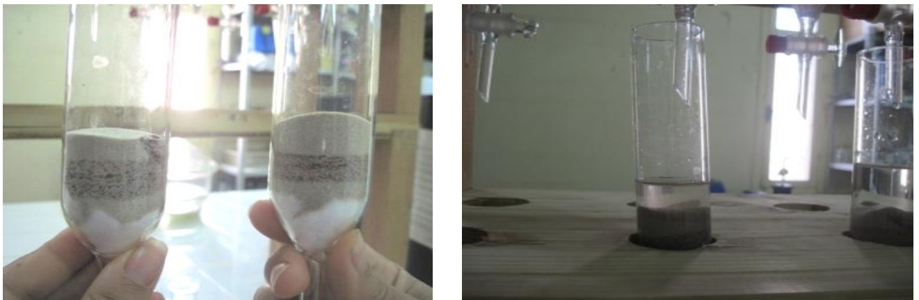
Photo 3 - Préparation des tubes des échantillons du sol et l'ajout de la solution pour chacune des étapes de saturation, lavage et déplacement
