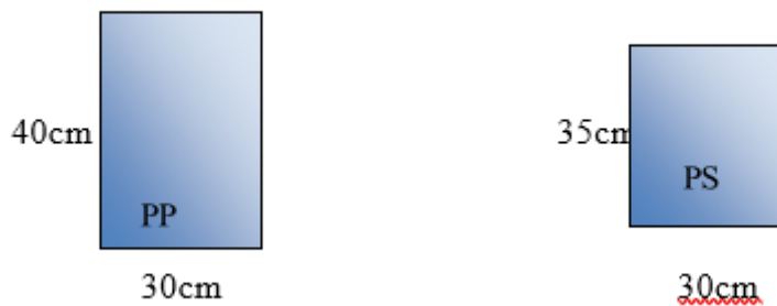
Fig.II 3: Les dimensions des poutres principales et secondaires.
