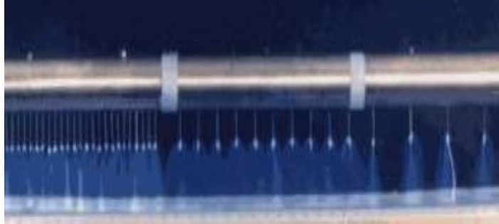
Figure I.3. Photographie d'une décharge couronne (pointes / électrode terre) [13] .
