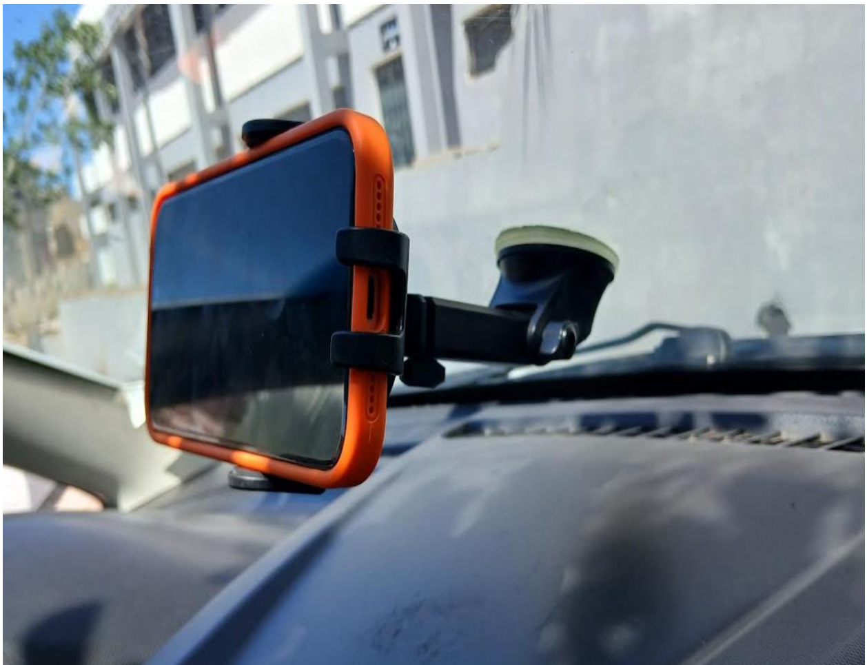
Figure III.1 : Système d'acquisition et enregistrement vidéo avec smartphone fixé sur le véhicule à l'aide d'un support
