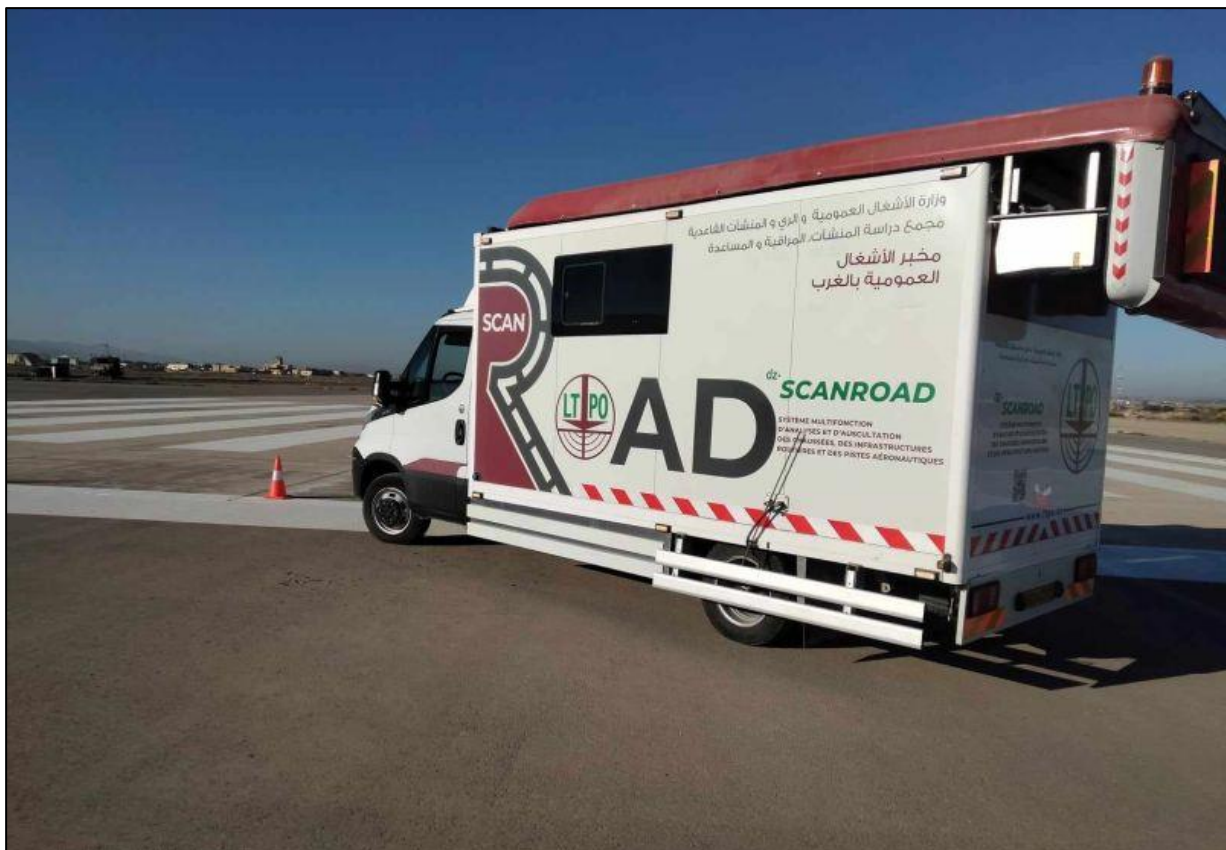
Figure I.21 : Véhicule d'auscultation routière automatisé « SCANROAD »
