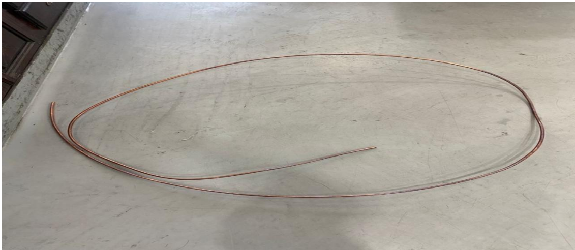
Figure III.12: échantillon de 1 m du ' fil machine \phi 8MM
