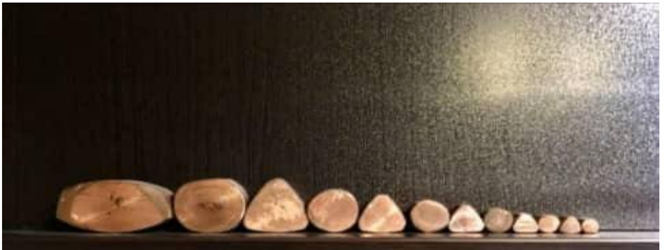
Figure III.10: Les étapes de réduction section de cuivre laminé
