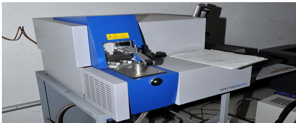
Figure III.5: Spectromètre d'analyse de la composition chimique GISB
