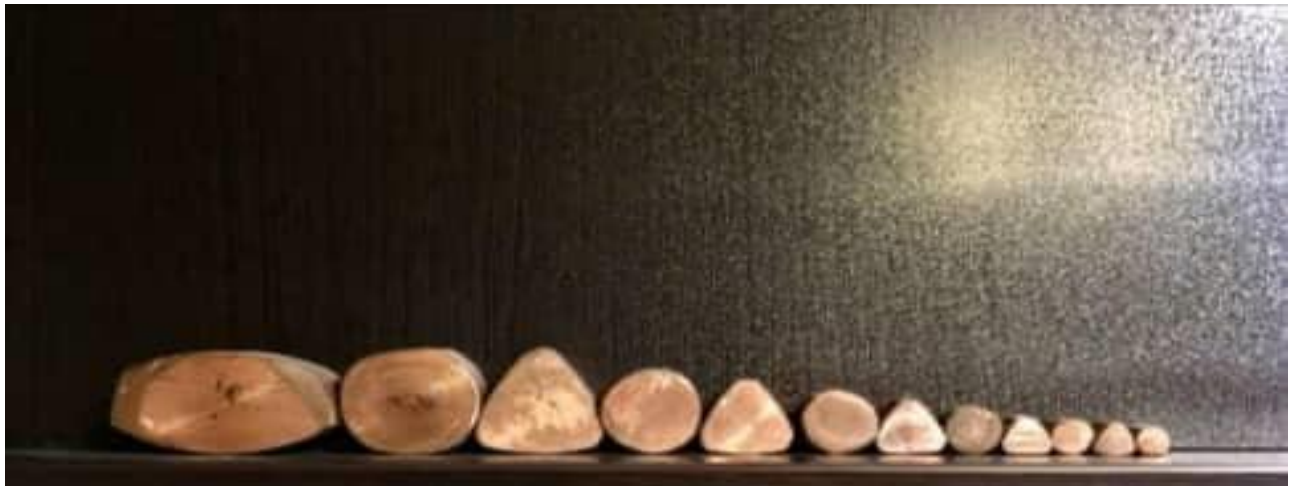
Figure III.10: Les étapes de réduction section de cuivre laminé
