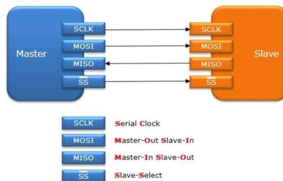
Figure 3.18 : Principe de fonctionnement du Protocol de communication SPI [48].
