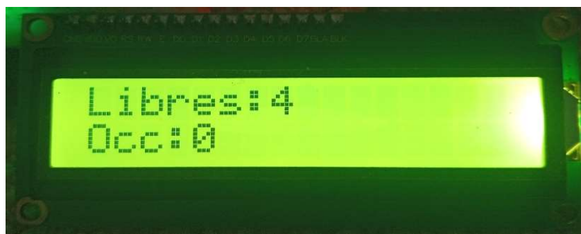
Figure 4.8 : Affichage de l'état de parking sur LCD.
