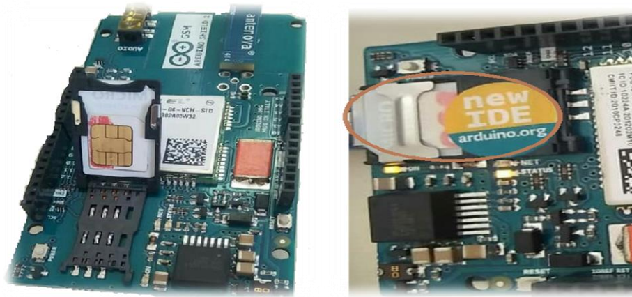
Figure 3. 6 : Insertion de la carte SIM
