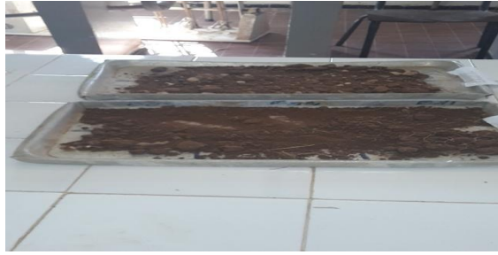
Figure 10: le séchage des sols étudiés à l'air.
