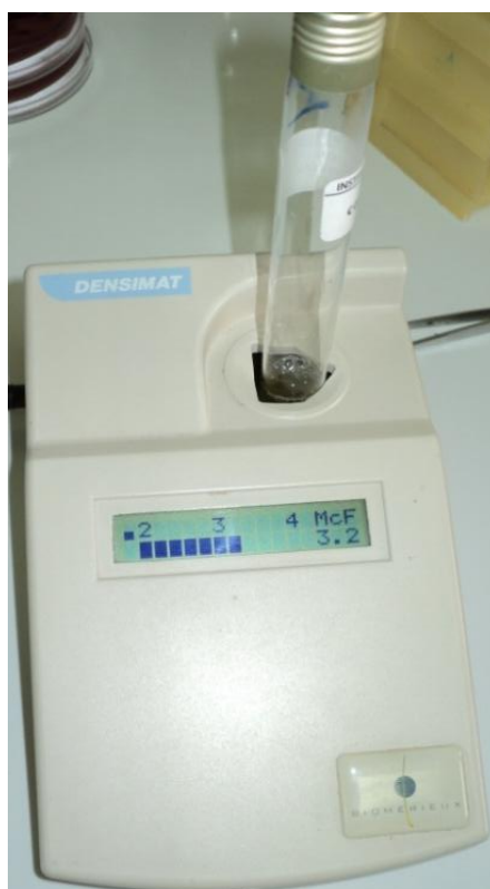
Figure n° 33: Ajustement de la turbidité à 3 McFarland à l'aide du densimètre
