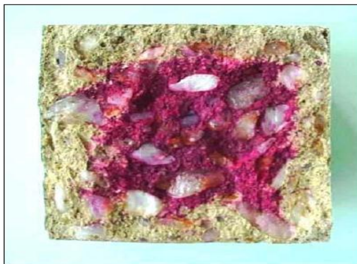
Figure 3.14: Exemple d'échantillon carbonaté
