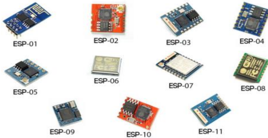
FigureII-6 : les versions du module ESP. [15].
