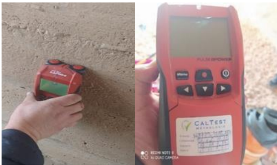
Figure III. 19 : Scanner mural multi-détecteur
