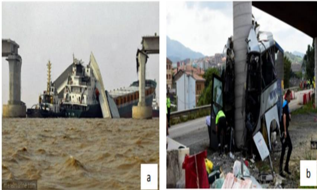
Figure I. 7 : Conséquences de collision contre la pile d'un pont : (a) Cas d'un bateau et (b) cas d'un véhicule ( Boutaraa, Z. (2019) )
