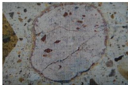
Figure II. 15 : Granulat fissuré par réaction alcalis silice (Kosmatka,Kerhoff et al)
