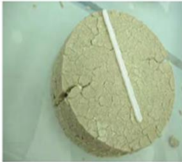
Figure II. 9: Fissures importantes d'un échantillon de béton soumis au test de résistance aux sulfates (Boutaraa 2021)
