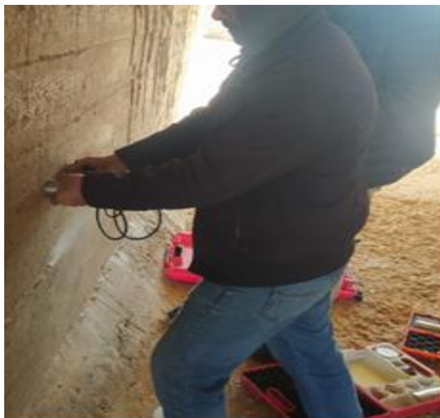
Figure III. 20 : Mesure de la vitesse de propagation (ultrason de type TICO).
