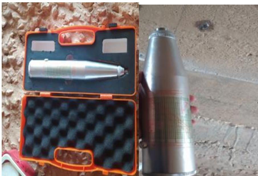
Figure III. 22: Appareil de mesure de la résistance de béton (scléromètre à béton).
