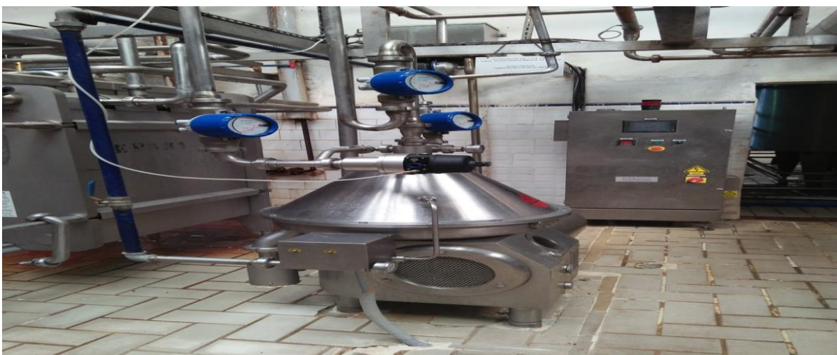
Figure 06 : Ecrémeuse utilisée par la laiterie de Giplait
