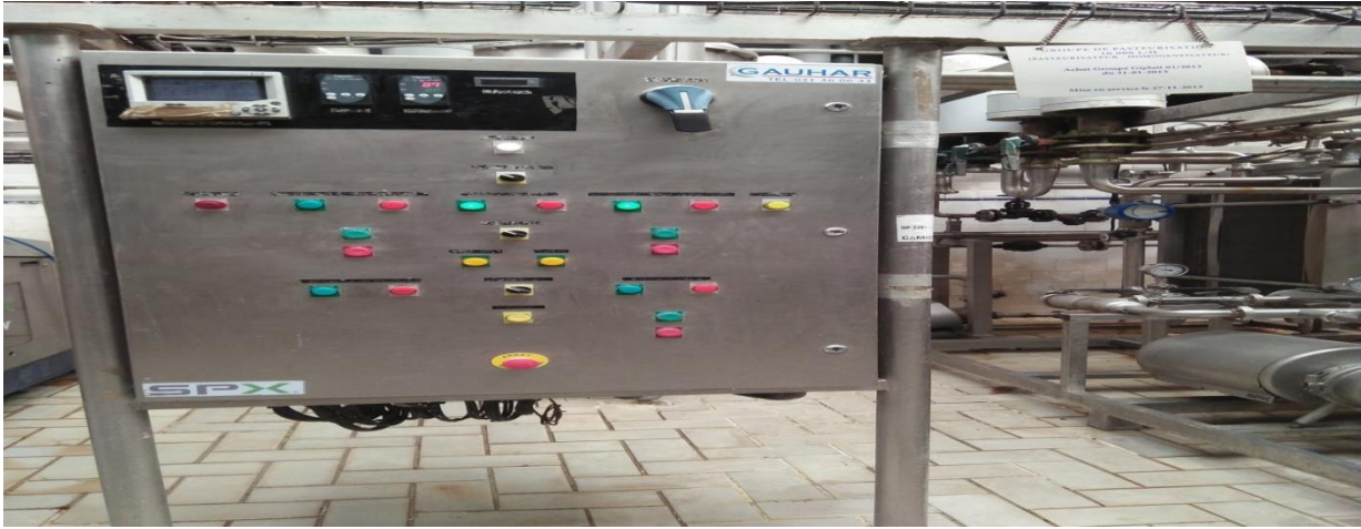
Figure 04 : Pasteurisateur – Homogénéisateur utilisé par la laiterie Giplait
