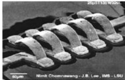
Figure II.4: Micro bobine solénoïdale.
