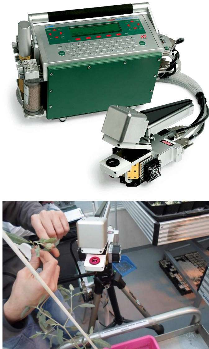
Figure 12 : Présentation du Licor 6400. Cet instrument est composé d'une console (conditionnement des gaz), et d'une tête (comprenant la chambre foliaire et les IRGA).Source : Licor, notice technique
