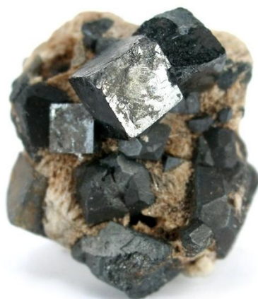
FIGURE. II.1 : La pérovskite Titanate de Calcium ( \text{CaTiO}_3 )
