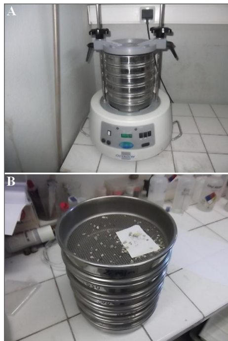
Figure 39 : Matériels utilisés pour l'analyse granulométrique réalisée au laboratoire de sédimentologie de l'université de Nice Sophia Antipolis. Tamiseuse mécanique de type OCTAGON (A) ; série de tamis correspondant à la série AFNOR (B).
