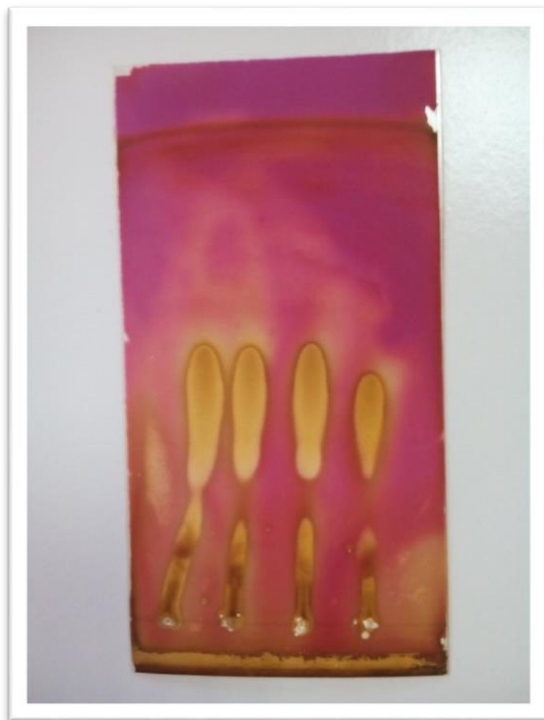
Figure 7. Résultat d'analyse de l'extrait du plante Acacia radiana par chromatographique sur couche mince (CCM) avec l'acétone
