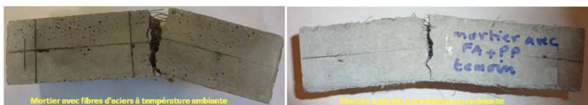
Figure 3.12 : Clichés de 2 éprouvettes fibrées après rupture.
