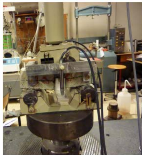
b) Zoom sur la ligne de chargement une fois l'éprouvette est détruite.
