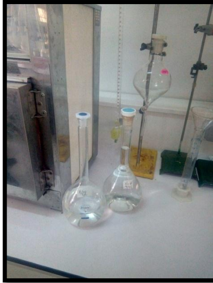
Photo 11 : Préparation de deux hydrolyses (acide sulfurique et la soude) (Ahmadou et Mekhlouf 2019)
