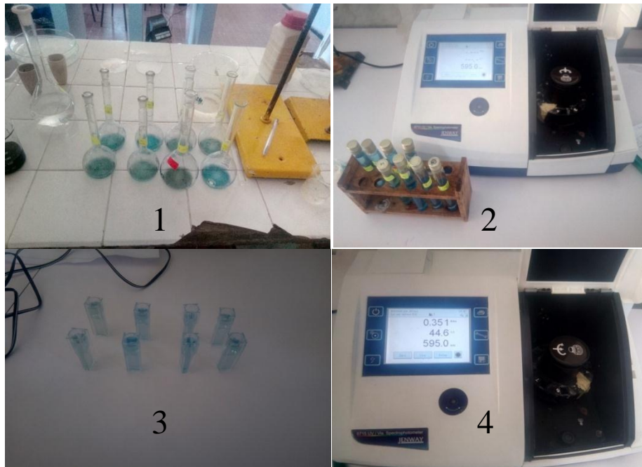
Photo16 : L'observation de la densité optique par Spectrocolorimètre (Ahmadou et Mekhlouf 2019)
