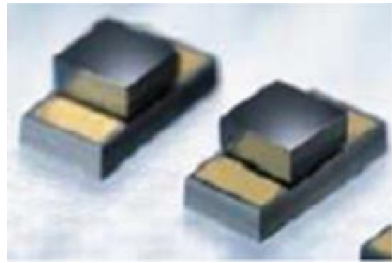
Figure I. 07 : Miniaturisation du Micropelt par rapport à un Peltier massif commercial et son agrandissement.
