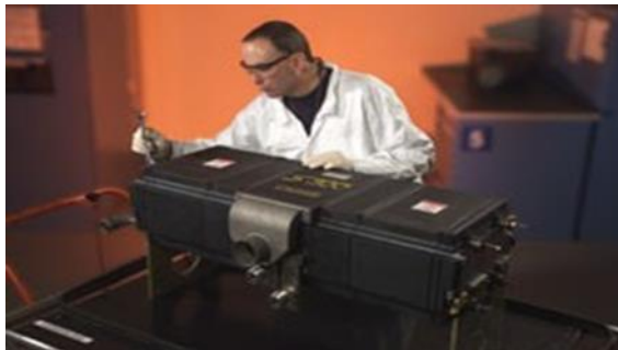
Fig.I.12 : Pile à combustible 75 kW UTC pour des voitures et des autobus.
