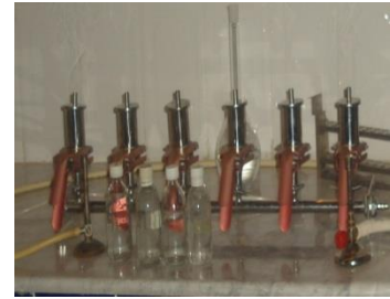
Figure N°04:Rampe de filtration
