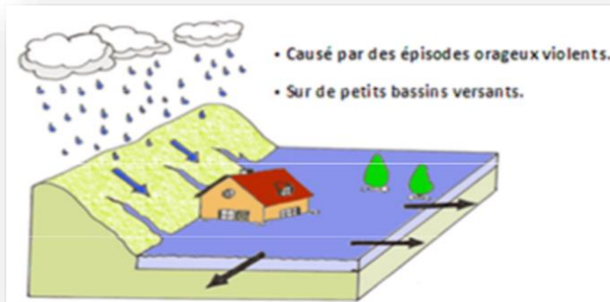
Figure 19 : Inondation par ruissellement en secteur urbain.
