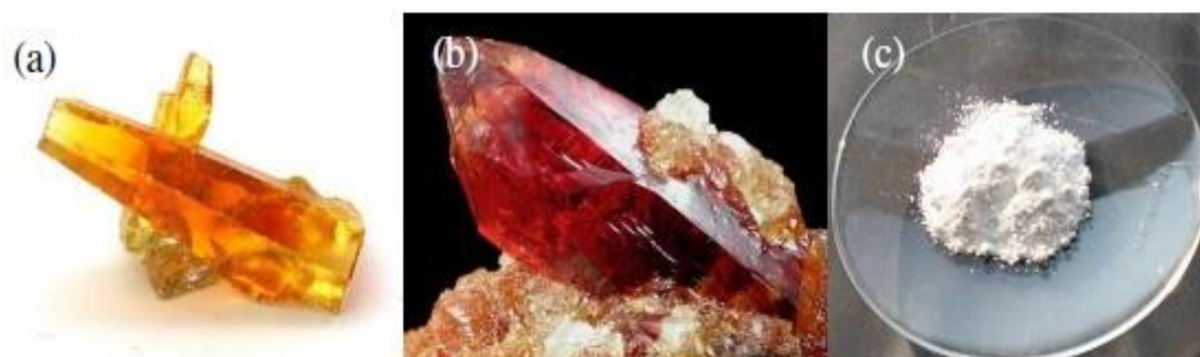
Figure I.4. Oxyde de zinc ( \text{ZnO} ) : (a, b) sous forme naturelle et (c) sous forme artificielle provenant d'une synthèse par précipitation.
