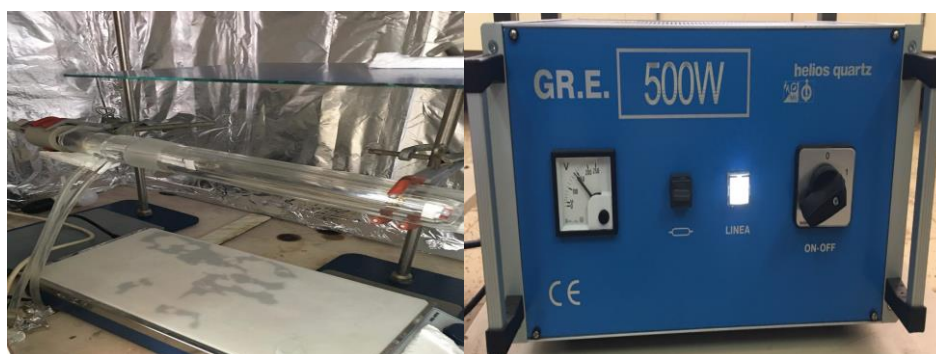
Figure II.1. Montage expérimental du réacteur photocatalytique. (Gauche) : lampe UV, (Droite) : stabilisateur (500W/150V)
