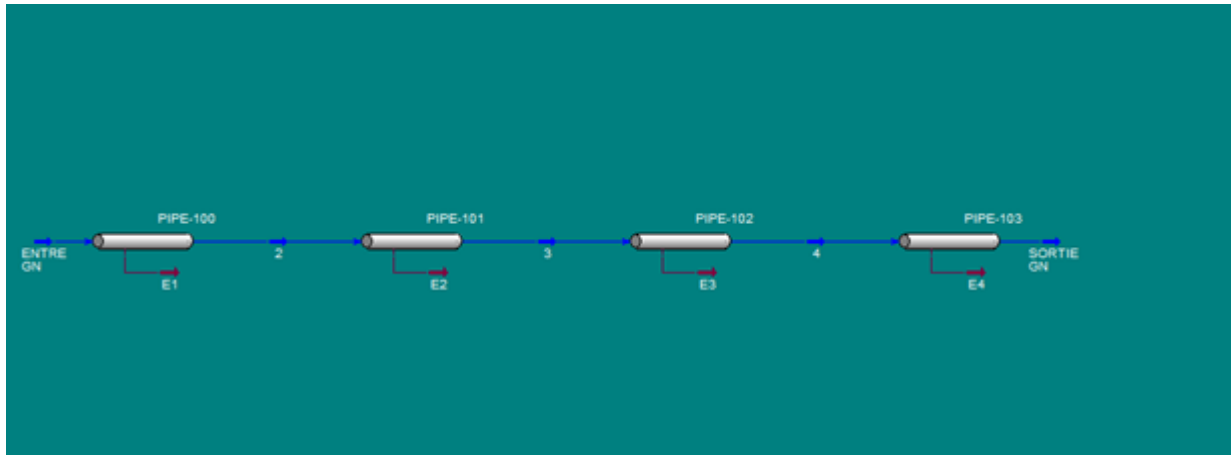
Figure II.1 : Schéma de simulation de la ligne GN à l’entrée de déshydrateur par HYSYS.
