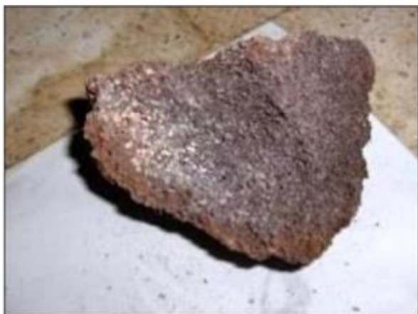
Photo 6 : Scories de la pouzzolane naturelle de Beni-Saf avant broyage
