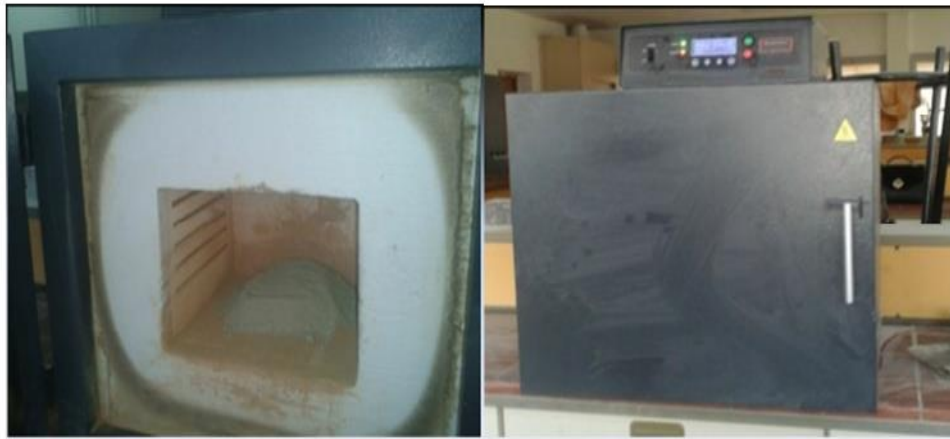
Photo 11 : Four de calcination utilisé (+ 1200°C).
