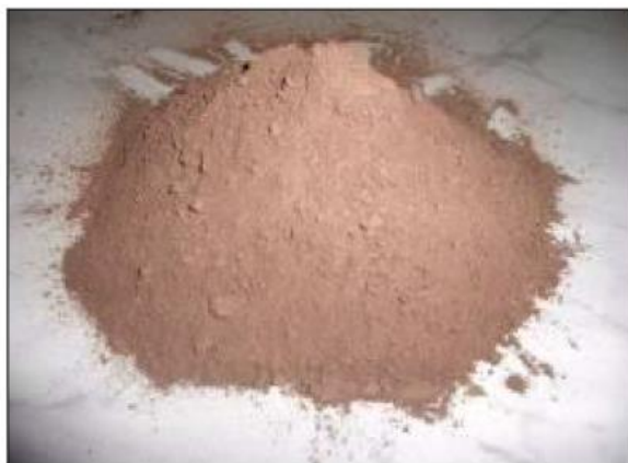
Photo 13 : Poudre de la pouzzolane naturelle de Béni-Saf broyée à 80 \mu\text{m} .
