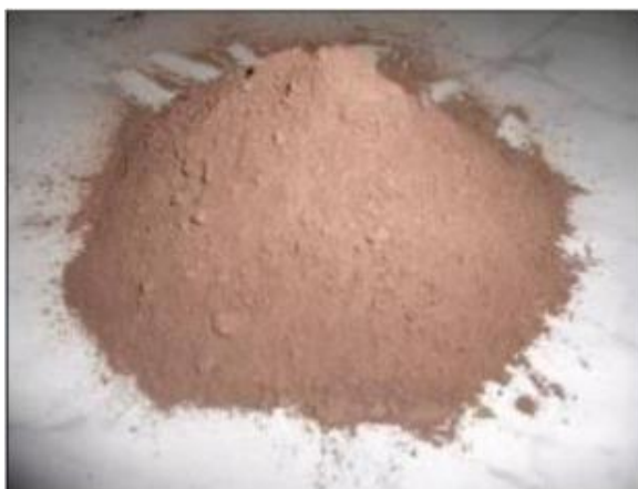
photo 7 : Poudre de la pouzzolane naturelle de Beni-Saf broyer à 80 \mu\text{m} .
