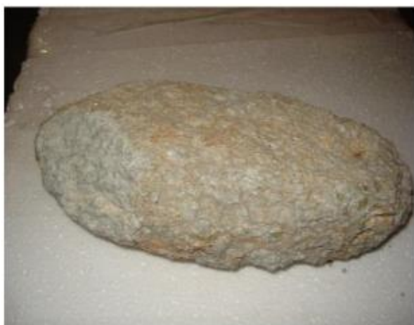
Photo 8 : Scories de la perlite de Hammam Boghrara avant broyage.
