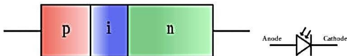
Figure (14) : structure d'une photodiode PIN.
