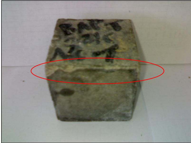
Figure III.26: Echantillons de BAP T, après 360 jours d'immersion dans la solution de 5% de \text{Na}_2\text{SO}_4
