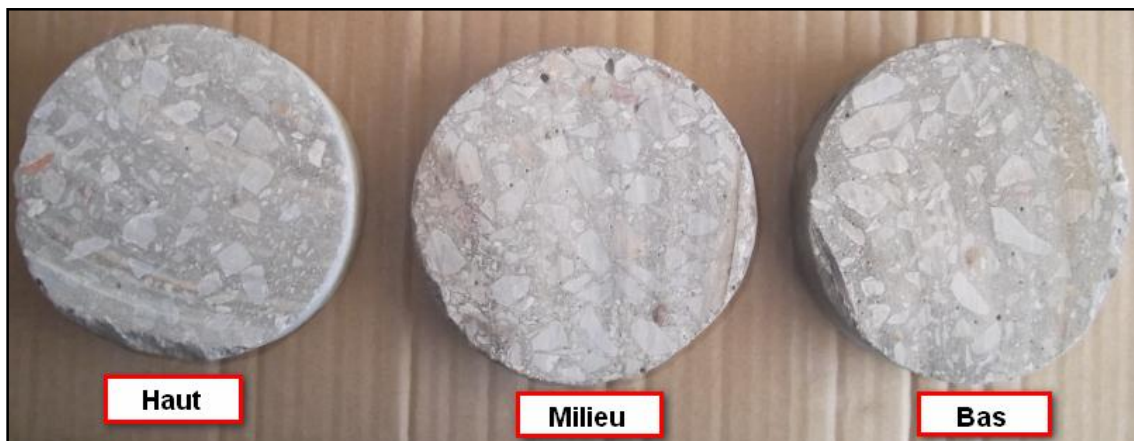
Figure III.17 : Observation de la répartition des granulats pour le BAP T.
