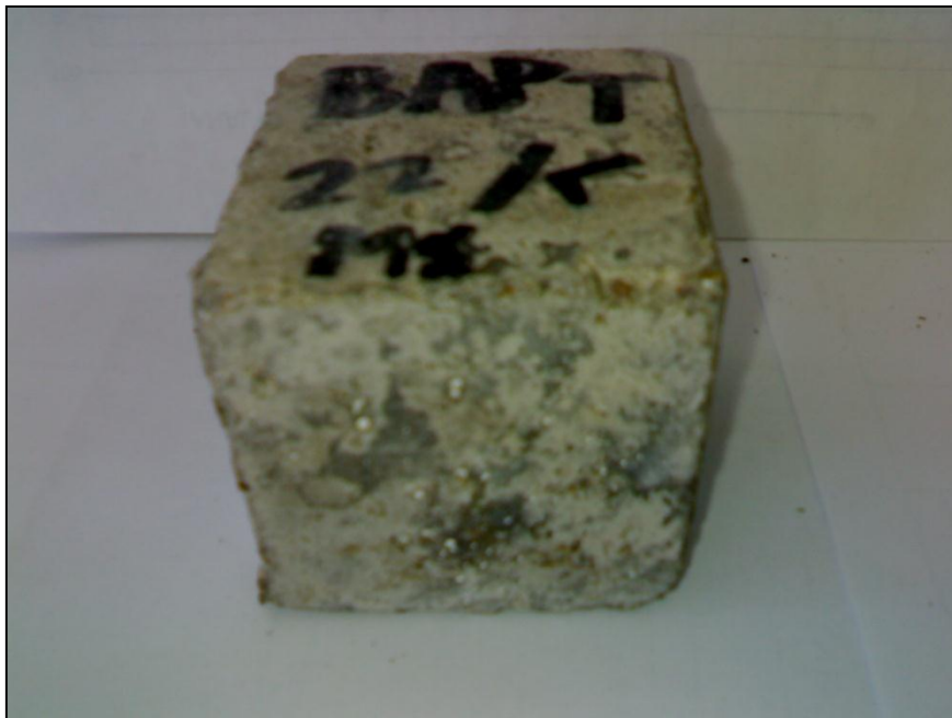
Figure III.30: Echantillons de BAP T, après 360 jours d'immersion dans la solution de 5% de MgSO_4
