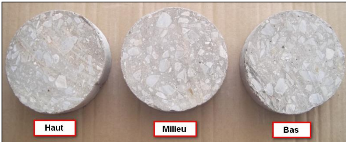
Figure III.18 : Observation de la répartition des granulats pour le BAP VF.
