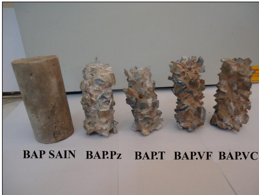
Figure III.32 : Dégradation des échantillons du béton après 6 semaines d'immersion dans la solution d'acide sulfurique.
