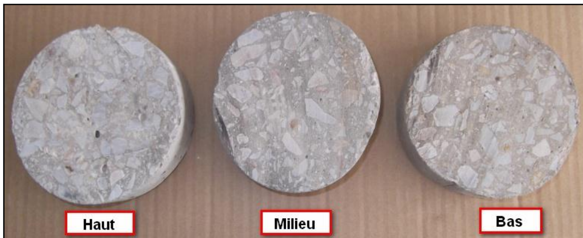
Figure III.19 : Observation de la répartition des granulats pour le BAP PZ.
