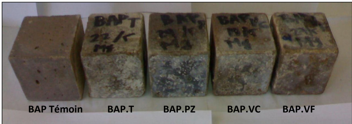
Figure III.29: Echantillons de différents bétons, après 360 jours d'immersion dans la solution de 5% de MgSO_4
