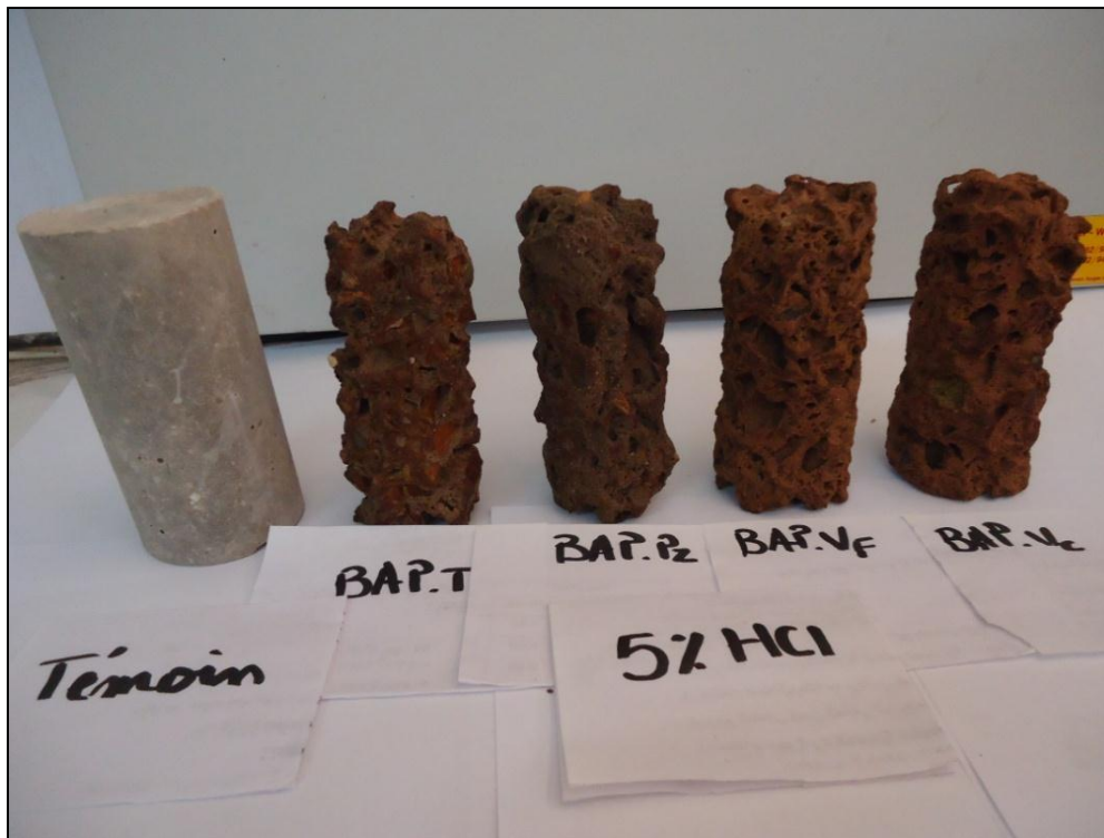
Figure III.34 : Dégradation des échantillons du béton après 4 semaines d'exposition aux solutions d'acide chlorhydrique.
