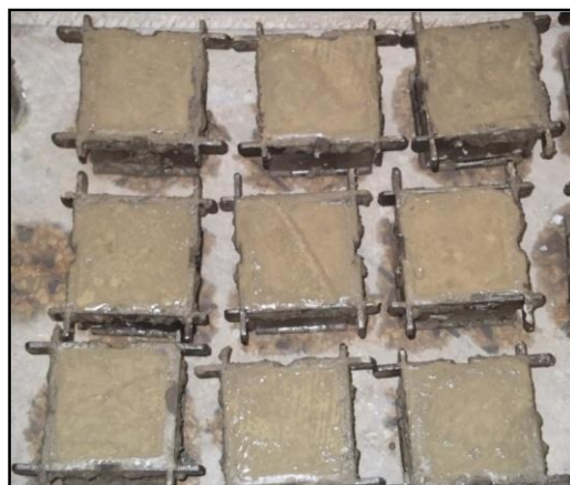
Figure II-14 : Coulage des moules (7x7x7) cm 3 .
