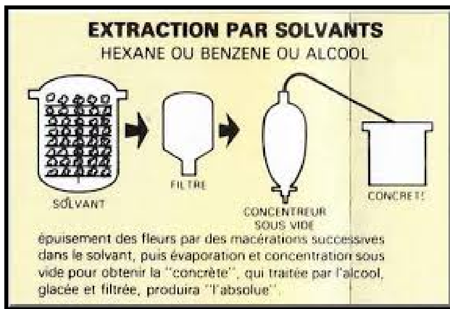
Figure 6 : Technique d'extraction par solvant (Anonyme 2 ,2010)
