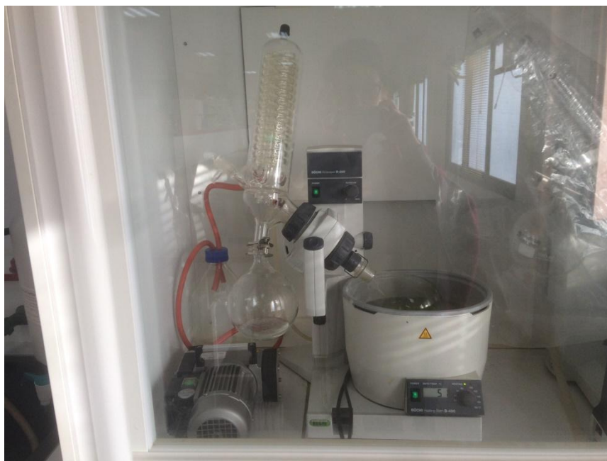
Figure 16 :Appareil du rotavapeur
