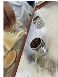
Mélange final homogène et coulé de l'échantillon
