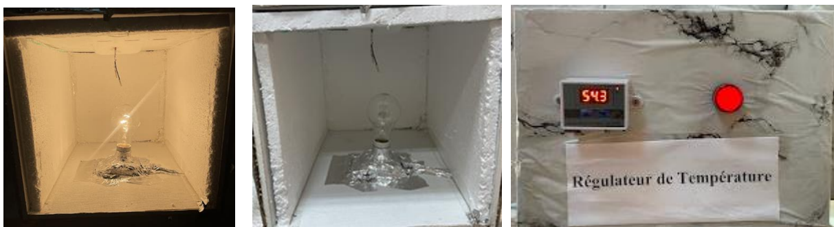
Figure 3.8 : Préparation du box chaud
