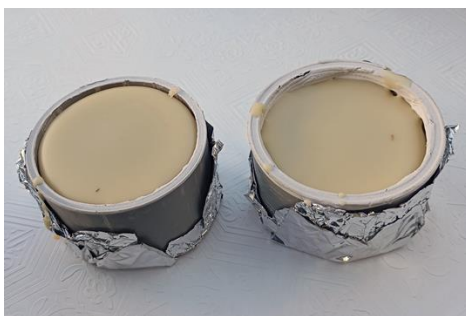
Figure 3.4 : Les échantillons réalisés pour la mesure des propriétés thermo-physiques.
