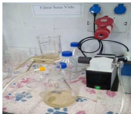
Figure 05 : filtrer sous vide
